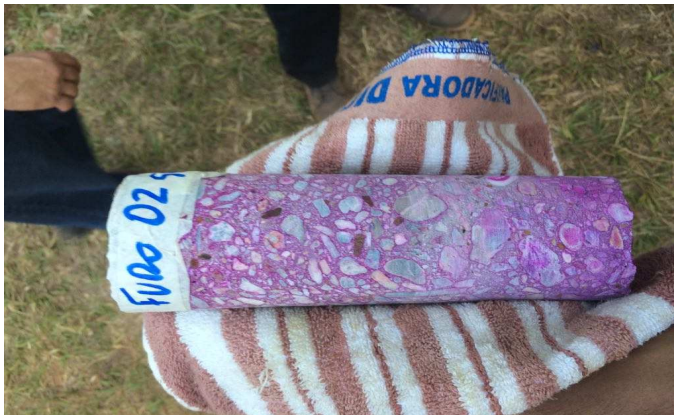
Extração de corpos de prova para realização de ensaios de resistência do concreto
